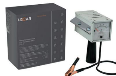
**Нагрузочные вилки** предназначены для определения степени заряженности и исправности автомобильной аккумуляторной батареи с номинальным напряжением 12 вольт, а также проверки исправности генератора бортовой сети с помощью высокоточного вольтметра.
