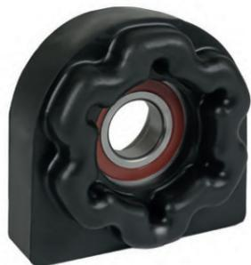
**Опора карданного вала** служит для компенсации центробежной силы и весовых нагрузок при большой длине сопряжения. Она не позволяет карданному валу провисать под собственным весом и отклоняться от оси вращения.
