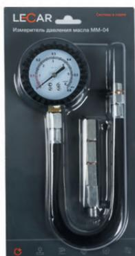
**Масломеры** используются для измерения давления в системах подачи масла для смазки элементов двигателя. Укомплектованы наконечником с резьбой M14 x 1,5 и комплектом переходников под другие посадочные резьбы. Диапазон измерения давления 0–0,6 МПа.
