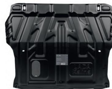
Защиты картера предназначены для предохранения от физических повреждений поддона картера и других рабочих механизмов.
